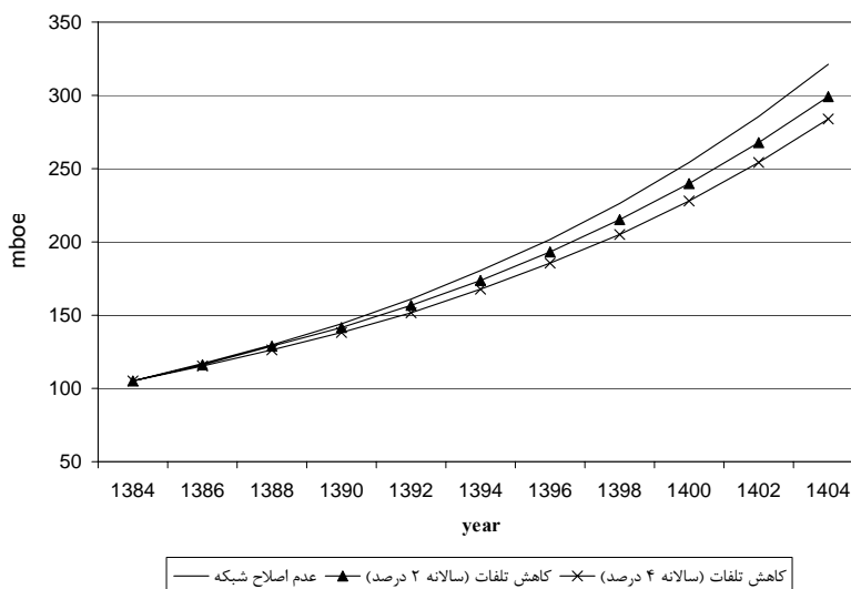
شکل ۶ - اثر کاهش تلفات انتقال شبکه‌ی انتقال و فوق توزیع بر انرژی الکتریکی مورد نیاز تولیدی
