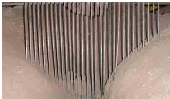
(شکل ۲) - نحوه اندازه گیری سطح مقطع خاک به هم خورده با استفاده از پروفیل متر
