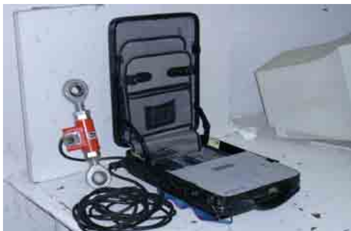
(شکل ۱) - لودسل و قسمت نمایش دهنده
