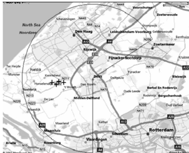
(شکل ۱) - نقشه قسمت غربی هلند با حداکثر طیف رادارهای هواشناسی SOLIDAR X-band به همراه موقعیت ایستگاههای باران سنج (+)
