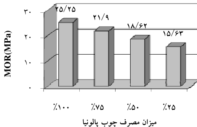
شکل 1 - اثر مقدار خرده چوب پالونیا بر مقاومت خمشی تخته خرده چوب
