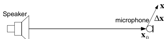
شکل ۴. آرایش بلندگوی ثانویه و میکروفن خطا در ANC
