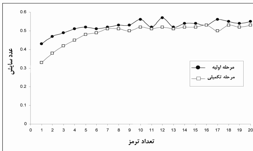
شکل ۶. نمودار عدد سایش بر حسب تعداد ترمز برای نمونه B-120Q.
