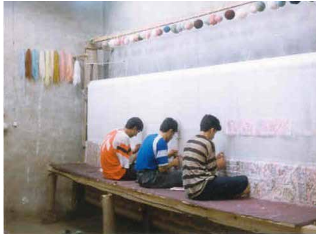
شکل ۱- سه بافنده به صورت چهارزانو بر روی تخته الوار که نقش نشستگاه را دارد نشسته‌اند و مشغول انجام عملیات بافت قالی هستند.
