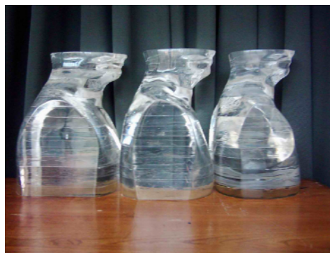
شکل ۱- تصویر فانتومها پس از اینکه روی آنها تراش و پولیش نهایی صورت گرفته است. از سمت چپ به ترتیب: چاق، متوسط و لاغر
