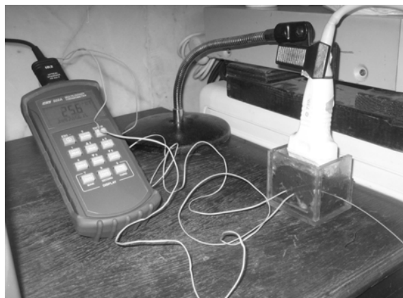
شکل ۲- چیدمان آزمایش شامل محفظه نگهدارنده، فیبر اپتیکی، پروب آلتراساند، ترمومتر، حسگرهای حرارتی و بافت کبد
