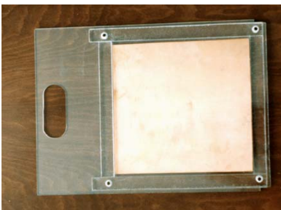
شکل ۱- نگهدارنده فیلترها در حالی که فیلتر مسی در محل مخصوص خود قرار دارد.
