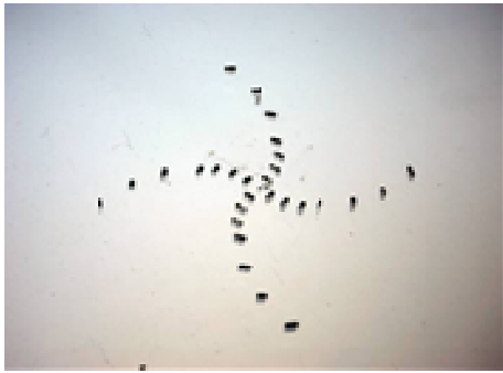
شکل ۳- طرح فانتوم برای محاسبه ثابت آهنگ دوز و تابع دوز شعاعی
