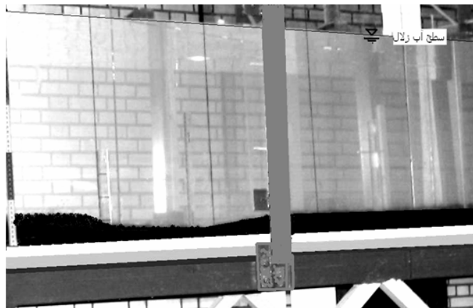
شکل ۴- اندازه گیری سرعت بدنه جریان غلیظ توسط دستگاه لیزر داپلر
