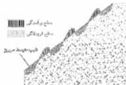
شکل ۶- تعادل بین حجم فرورفتگی‌ها و برآمدگی‌ها در سرریز پلکانی مرکب
