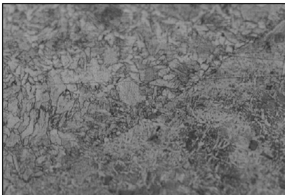
شکل ۴: تصویر نشان دهنده مرز اتصال با بزرگنمایی ۲۰۰.
