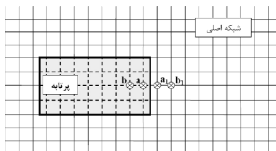
شکل (۴): شکل شماتیک شرایط مرز متحرک
