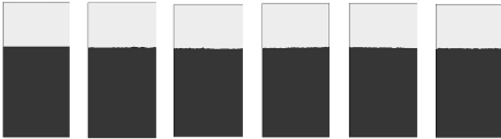
شکل (۳): سطح آزاد مایع در لحظات مختلف در اثر اعمال ضربه ناشی از نیروی ۴۰۰ کیلونیوتن، از چپ به راست لحظات صفر، ۱، ۲، ۳، ۴ و ۵ ثانیه.
