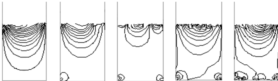
شکل (۴): خطوط جریان در لحظات مختلف در اثر اعمال ضربه ناشی از نیروی ۴۰۰ کیلونیوتن، از چپ به راست لحظات ۱، ۲، ۳، ۴ و ۵ ثانیه.
