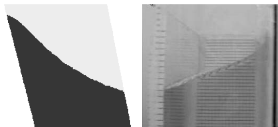
شکل (۸): مقایسه شکل سطح آزاد مایع متلاطم شده حاصل از روش تجربی و حل عددی تحت تأثیر ضربه ناشی از نیروی ۵,۰۰۰ کیلو نیوتن در ثانیه دوم.
