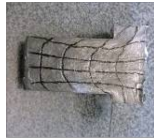
شکل (۹): بیلت خروجی دو تکه اکستروژن دایره به مربع.
