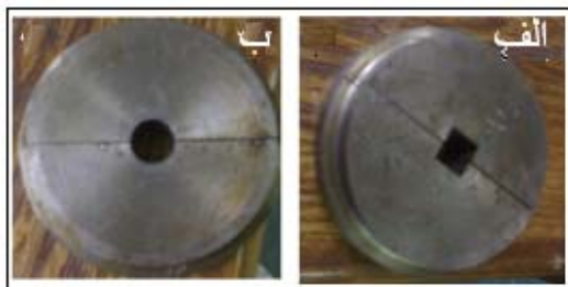
شکل (۷): قالب دو تکه؛ الف) ورودی دایره به خروجی مربع ب) ورودی دایره به خروجی دایره.
