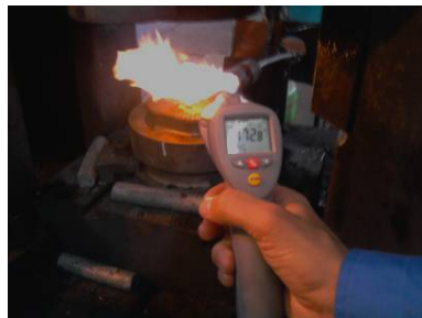
شکل (۱۳): عملیات پیش‌گرم قالب‌ها و اندازه‌گیری
