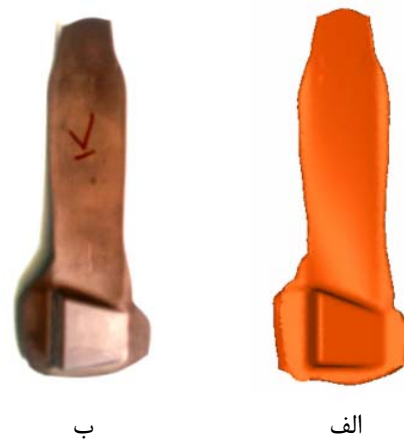
شکل (۲۰): مقایسه پره فورج شده؛ الف) المان محدود ب) تجربی.
