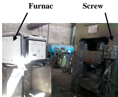
شکل (۱۲): موقعیت کوره و پرس هنگام عملیات فورج.
