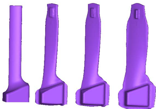
شکل (۹): روند تغییر شکل و جریان مواد از قطعه پیش‌فرم تا شکل نهایی.
