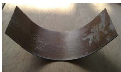
شکل (۸): تصویر نمونه ورق فولادی به ضخامت ۱ میلی‌متر پس از فرآیند.
