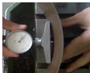
شکل (۱۶): نحوه اندازه‌گیری شعاع خمش نهایی ورق.
