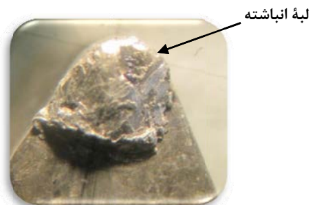
شکل (۸): تشکیل لبه انباشته بر روی ابزار سرعت ماشین کاری 60 \text{ m/min} ، نرخ پیشروی 0.08 \text{ mm/rev} و عمق تراش 0.8 \text{ mm} .
