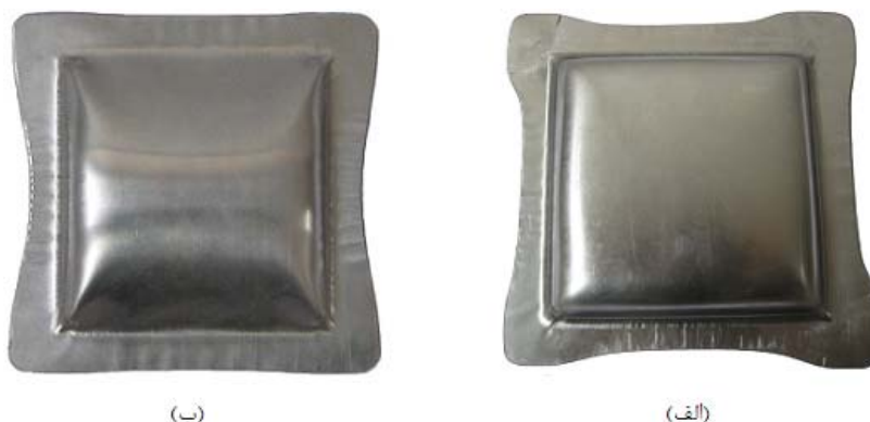
شکل (۱۲): نمونه‌ای از دیگر قطعات شکل داده شده با استفاده از قالب شکل دهی چند نقطه‌ای ساخته شده (الف) قطعه مربعی، (ب) قطعه با سطح استوانه‌ای با شعاع ۱۰۰ میلی‌متر.
