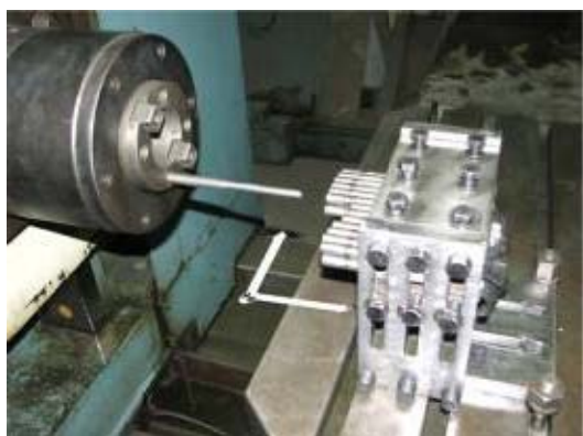
شکل (۶): روش نیمه‌اتوماتیک موقعیت‌دهی پین‌ها توسط یک دستگاه فرز CNC.
