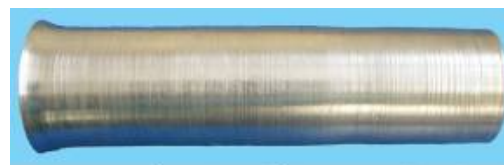
الف- لوله اولیه؛ t_0 = 1/5 \text{ mm} ، L_0 = 200 \text{ mm} ، D_0 = 50 \text{ mm}
