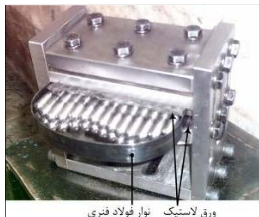
شکل (۴): قالب ساخته شده به همراه نوار فولاد فبری.
