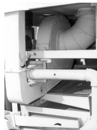
شکل ۵- دمنده کمباین و کانال انتقال جریان
