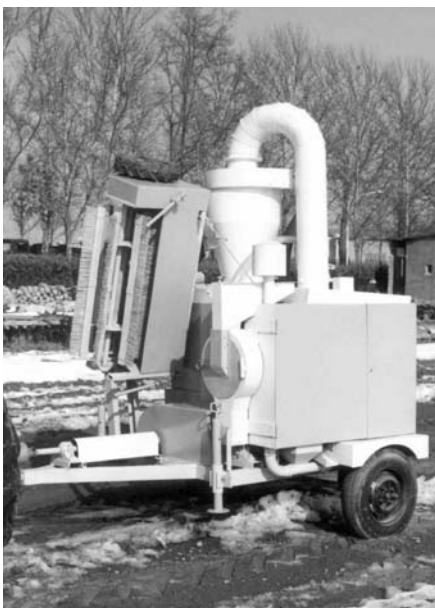
شکل ۴- نحوه جمع شدن سکوی برداشت
