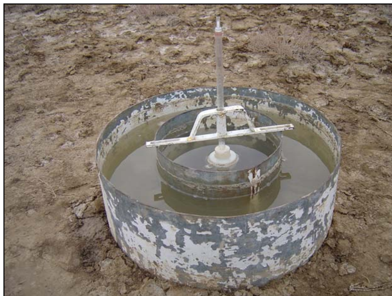
شکل ۳- حلقه‌های زوجی (دابل‌رینگ) برای اندازه‌گیری نفوذپذیری
