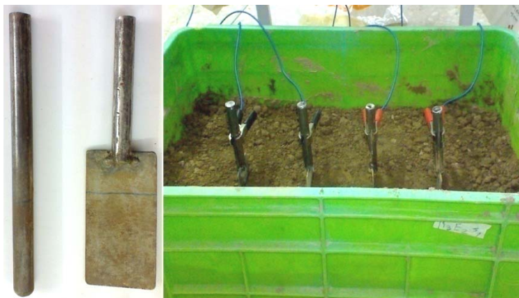
شکل ۳- راست: چیدمان قرار گیری الکترودها درون جعبه خاک، چپ: الکتروده صفحه ای و الکتروده میله ای
