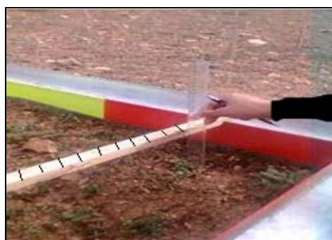
شکل 3- اندازه‌گیری پستی و بلندی خرد در فلوم‌های آزمایشی
