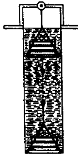
شکل ۱- روش نفوذ تحت فشار محلول کلرور کلسیم در میوه سیب.
