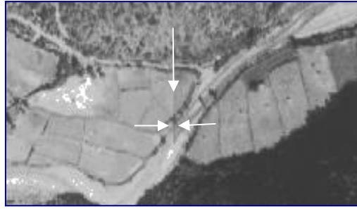
شکل ۲- محل اتصال دو تصویر تصحیح شده مجاور. ارتفاع منطقه حدود ۲۰۰۰ متر است.
