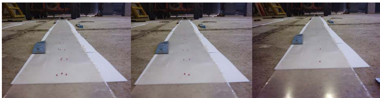
شکل ۳- تصویر نوار چسب زیر ردیف‌کار نیوماتیک بذر گوجه‌فرنگی در وضعیت تک‌دانه‌کاری، دودانه‌کاری و کپه‌کاری.
