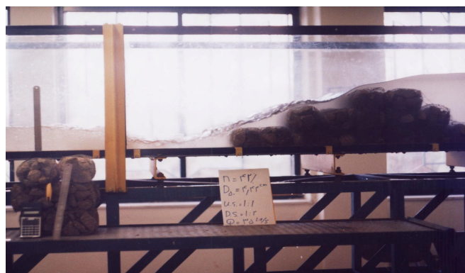
شکل ۱- سرریز پلکانی گابیونی در تخلخل ۴۲ درصد، شیب پایین دست ۱:۲، دبی ۳۵ لیتر بر ثانیه.
