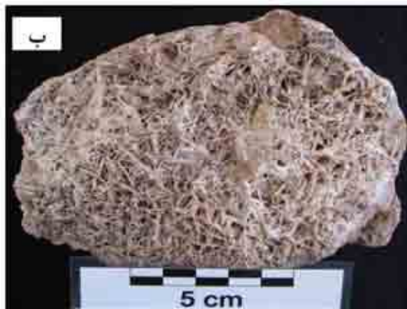
شکل ۱۳ نمونه‌های دستی مربوط به باریت. الف - بافت تیغه‌ای باریت همراه با بافت پوششی (Coating) منگنز ، ب - بافت جعبه‌ای باریت.
