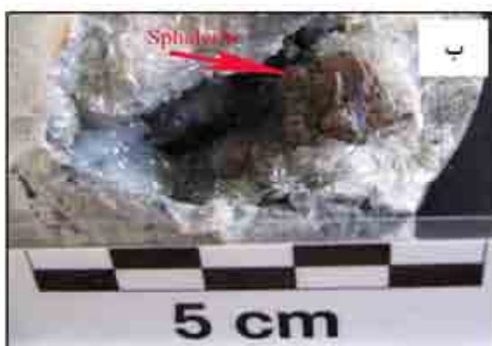
شکل ۶ نمونه دستی متعلق به اسفالریت کم آهن در الف و اسفالریت غنی از آهن در ب.
