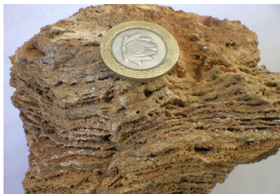
شکل ۲ تصویری از یک نمونه اسمیت زونیت از کانسار برفکه در نمونه دستی که حاوی بافت نواری یا لایه‌ای است.
