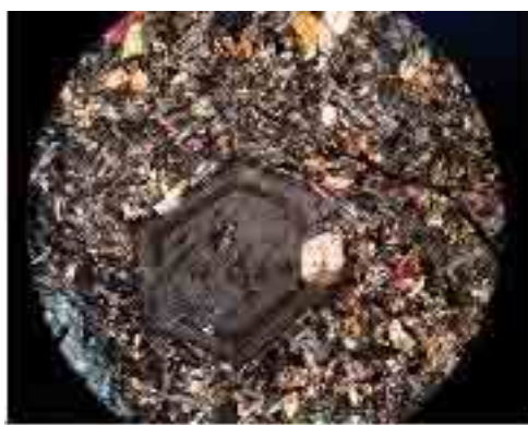
شکل ۲ نمایی از بلور اوژیت با ساختار منطقه‌ای (با آنالیزور).
