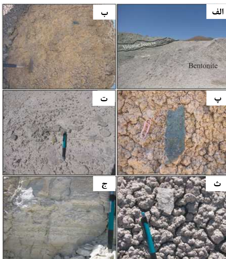
شکل ۴ الف) نمایی از لایه‌بندی در واحد برش آتشفشانی در تماس با بنتونیت‌ها (ب) وجود قطعاتی از واحد برش آتشفشانی در بنتونیت‌ها (پ) بافت پورفیری در قطعه‌ی برش ولکانیکی موجود در بنتونیت‌ها (ت) نمایی از ماسه سنگ آتشفشانی (سنگ مادر بنتونیت) (ث) حضور ژئیس در بنتونیت (ج) وجود لایه‌بندی در بنتونیت‌های منطقه.
