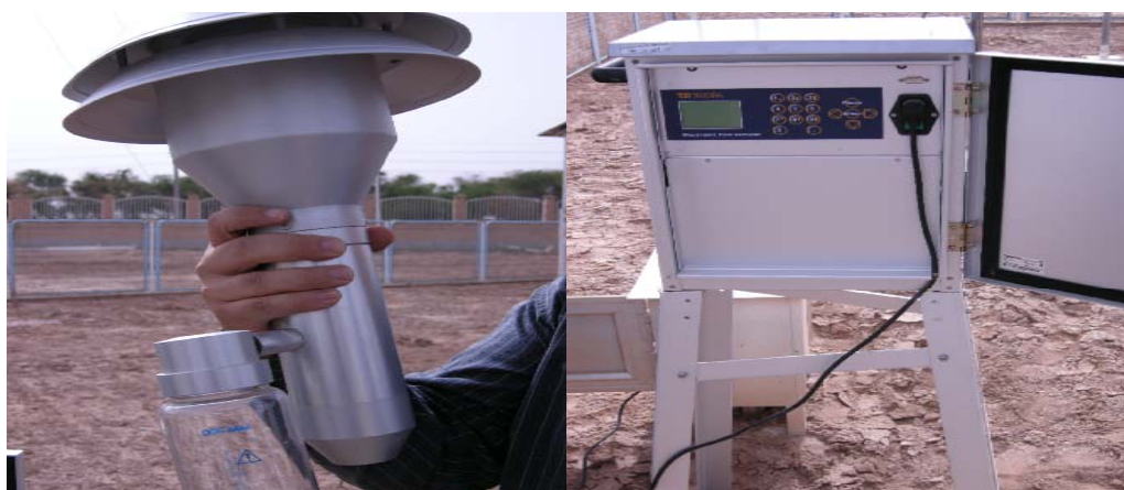
شکل ۲ نمائی از Pump دیجیتالی و تنظیمات دستگاه TECORA (سمت راست) و نمائی از جمع کننده، دستگاه TECORA (سمت چپ) در ایستگاه اهواز.
