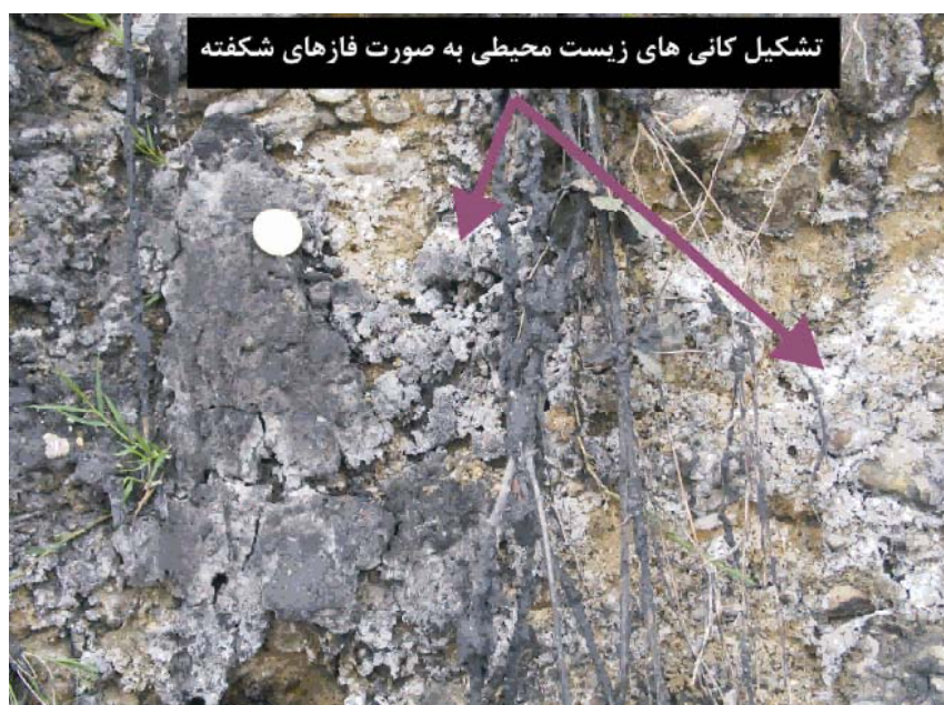
شکل ۲ تشکیل کانی‌های ثانویه (زیست محیطی) بر روی انبارهای باطله‌ی کارخانه زغال‌شویی وطنی.
