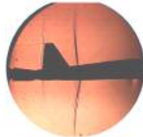
شکل ۳-ه) موج ناپایا در انتهای مدل با دم عمودی دوتایی در زمان راه اندازی تونل، \alpha=0^\circ
