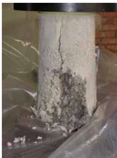
شکل ۱- وضعیت شکست در بتن معمولی
