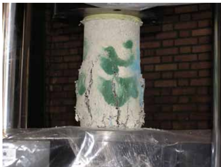
شکل ۳- انتشار یکنواخت و آرام خرابی در نمونه C25
