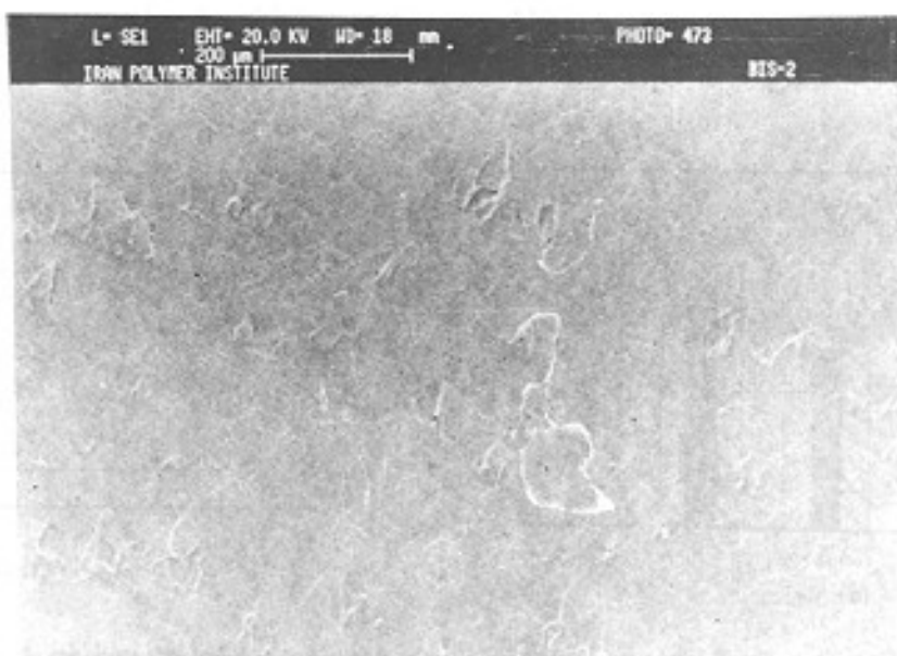
شکل ۶- عکس SEM سطح مقطع شکست نمونه شامل ۲ درصد Bis-GMA با بزرگنمایی ۱۰۰.
