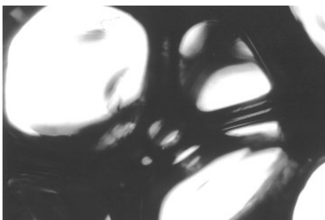
شکل ۶- عکس میکروسکوپ نوری نمونه ششم اسفنج پلی یورتانی تهیه شده از پلی ال ۲ با ۵/۸g کاتالیزور آلی - فلزی (بزرگنمایی ۲۵).
