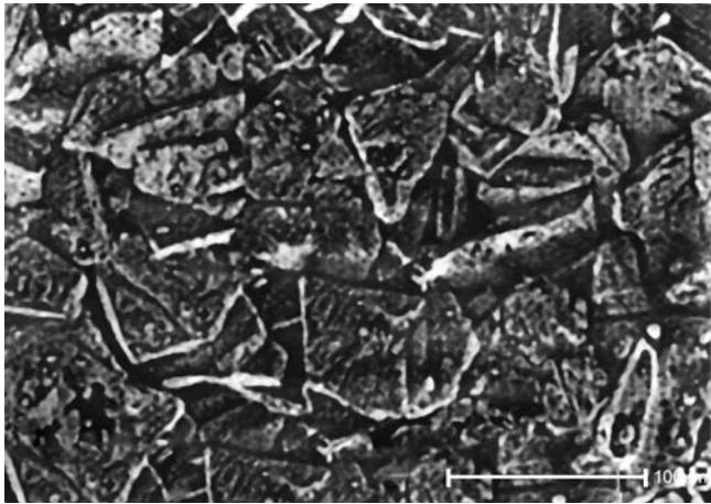
شکل ۳- تصویر میکروسکوپ الکترون پوششی ذرات آلیاژ مغناطیسی کوچکتر از 100 \mu\text{m} .
