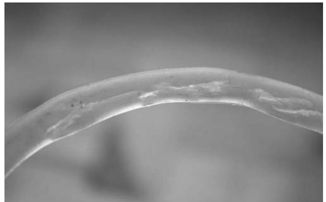
شکل ۸ - سطح مقطع واشر حلقه‌ای پس از قرار گرفتن بین دو صفحه پرس.
