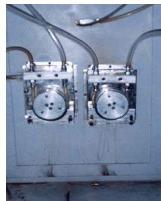
شکل ۳: پمپهای پرستالتیک تنظیم کننده دبی ورودی و خروجی خوراک و ته ریز.
