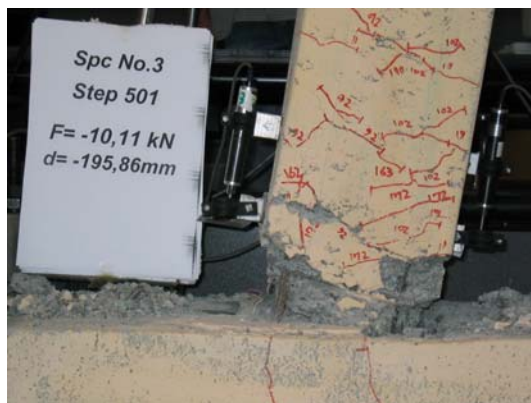
شکل ۱۰: نحوه تخریب در نمونه SBC-3 (الف) در جابه‌جایی جانبی ۶۴ میلی‌متر (ب) انتهای بارگذاری.
