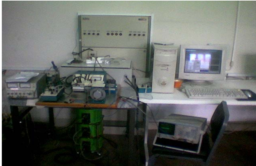
شکل ۶: سروموتور DC و کنترل کامپیوتری.
