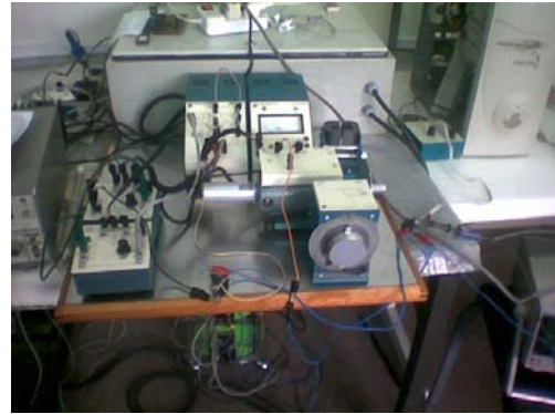
شکل ۴: سرو موتور آزمایشگاهی و واحدهای مربوط به آن.
