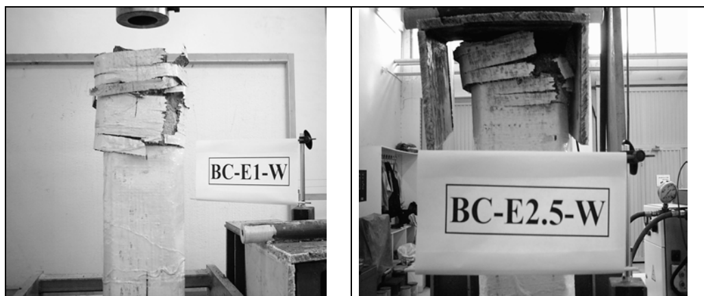
شکل ۵: انهدام دو نمونه ستون بار گذاری شده.
