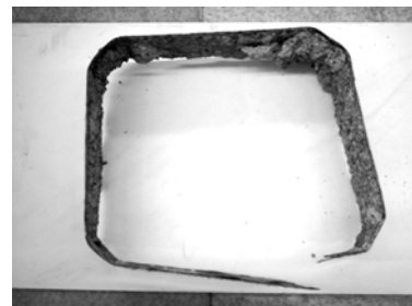
شکل ۶: نحوه گسیختگی دورپیچ CFRP.
