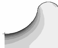
شکل ۹: کانتور توزیع کرنش پلاستیک معادل در پایان فرایند آهنگری دو مرحله ای [ مرجع ۱۲ ].
