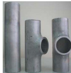
شکل ۱۶: دو نمونه از قطعات نهایی تولید شده به همراه لوله اولیه.
