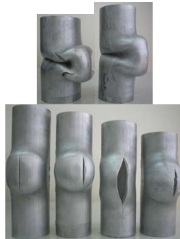
شکل ۱۸ الف: قطعات چروک خورده.
