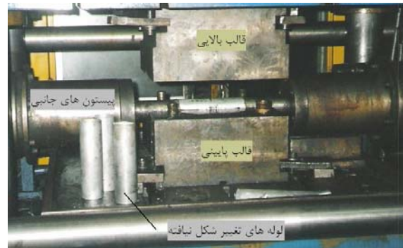
شکل ۱۴: موقعیت قالب و لوله و تعدادی از قالب های تغییر شکل نیافته.
