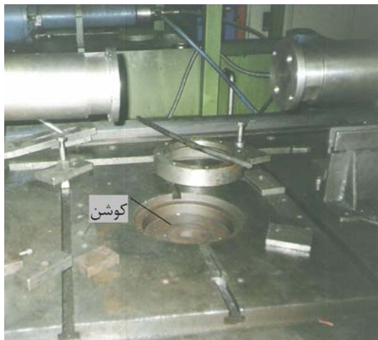
شکل ۲۰: کوشن در حالتی که قالب پایینی برداشته شده است.
