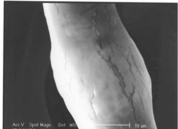
شکل ۱: تصویر میکروسکوپ الکترونی لیف پلی استر متورم شده توسط امواج الکترونی.
