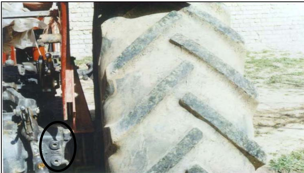
شکل ۳: محل نصب واحد ذخیره نیرو
