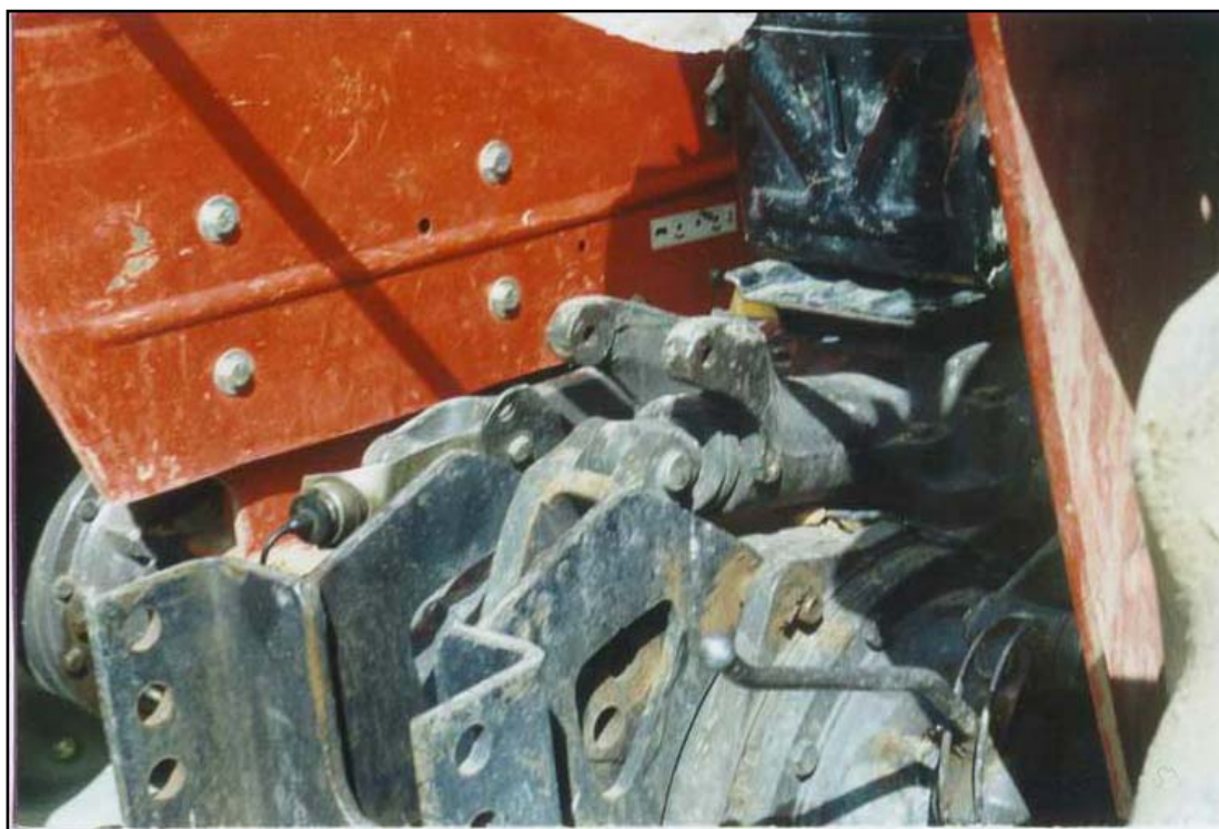
شکل ۶: محل نصب حسگر وضعیت اتصال سه نقطه
